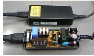
電源アダプタに使われているAC-DCコンバータ
