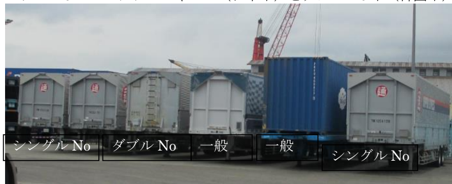
図-25 シングル No のコンテナ・シャーシ（日本車）とダブル No 車（韓国車）
