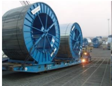
図-9 EU タイプの大型機械・特殊貨物用極低床車および牽引車
