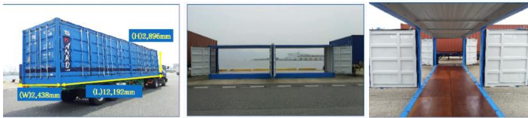
図-39 (再掲) 40ft 3面サイドオープン・コンテナ (国際標準, 積載効率が高い)
