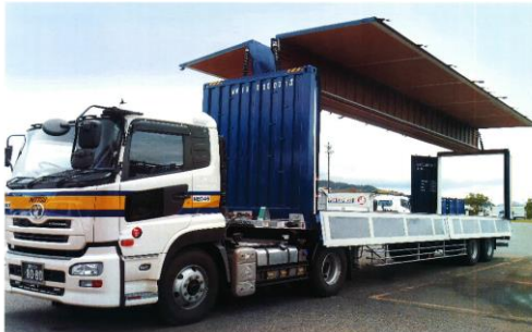
図-38（再掲）40ft 国際標準ウイング付きコンテナの場合
