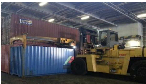
図-21 高速船内状況：コンテナ 2 段積
