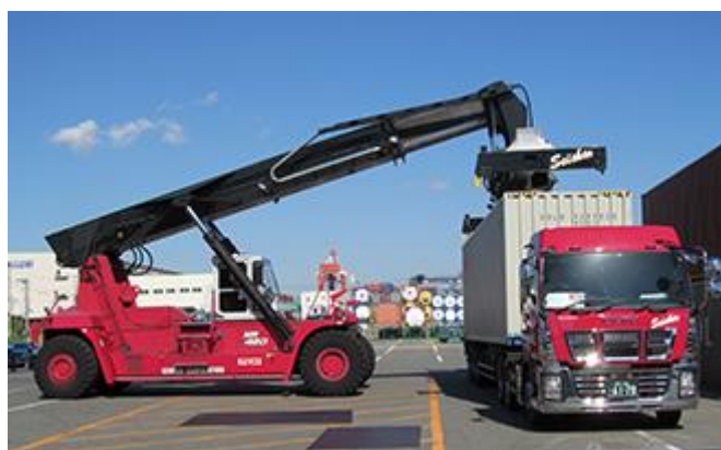
図-19 港湾区域でリーチ・スタッカーによるトレーラへのコンテナ荷役 (従来)
