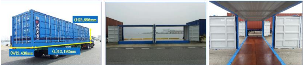
図 - 27 40ft 3面サイドオープン・コンテナ (国際標準, 積載効率が低い)
