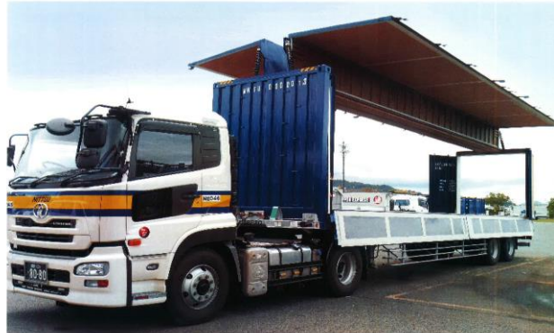
図 - 26 ウイング付きコンテナ (シャーシとは分離 : 国際標準コンテナ) (日通)
