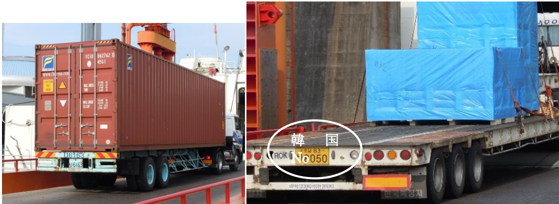
図-15 従来型 1 のコンテナ+シャーシ 図-16 従来型 1 の韓国特別認可シャーシ No 車
