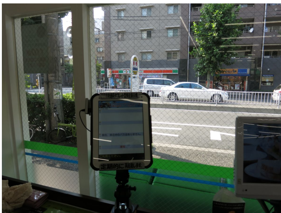
図 2.3 ファミリーマート和田屋万世町店のタブレット型バス接近表示機
